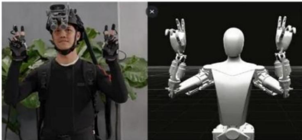
图：特斯拉第一代数采方案：动捕手套+动捕服
